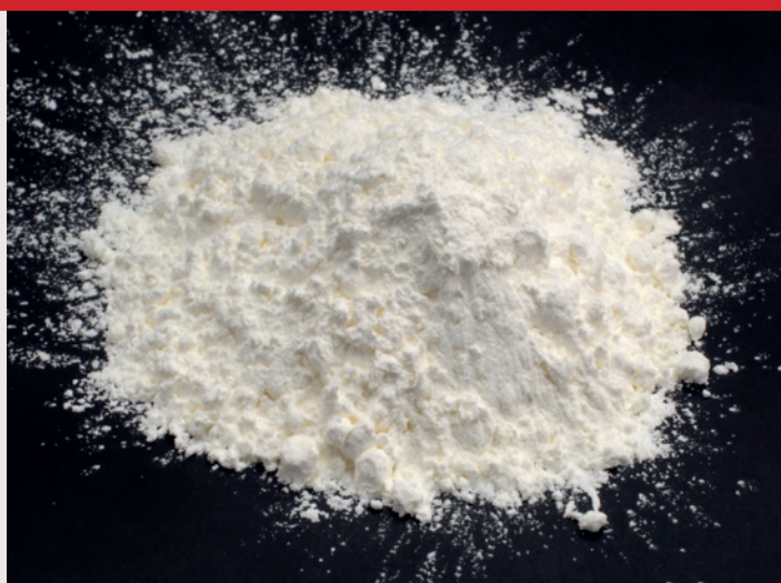
Per il caso specifico dei biopolimeri da amido in blend è consigliabile utilizzare in fase di stampaggio a iniezione degli agenti distaccanti o di protezione dello stampo e inserire sfiati per favorire il degasaggio.
