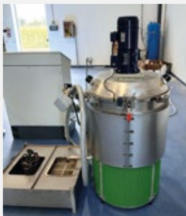
Impianto di lavaggio
